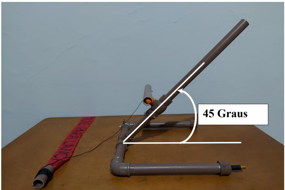
Vista lateral da base de lançamento do foguete no nível 1, mostrando a inclinação de 45 graus do tubo de lançamento. Assista ao vídeo do funcionamento dela explicado pelo Prof. Canalle:
