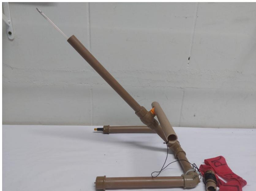
A foto acima mostra o foguete canudinho já posicionado dentro do tubo de lançamento. Ao se pressurizar a base com uma bomba de encher pneu de bicicleta e puxar o gatilho o foguete será lançado ao espaço. Assista ao vídeo do funcionamento dela explicado pelo Prof. Canalle: <https://www.youtube.com/watch?v=detzmuToUkE>
