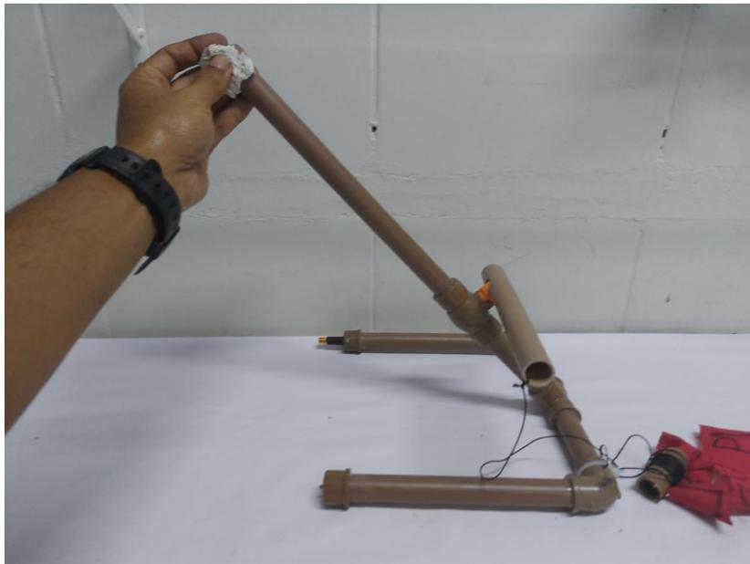
Na foto mostramos uma bolinha ou “bucha” de papel amassado (mas pode ser de pano, papel higiênico, espuma, etc) sendo colocada dentro do tubo de lançamento. Esta bolinha servirá de “apoio” para o foguete e será expelida pelo ar comprimido ao se puxar o gatilho, empurrando assim, violentamente, o foguete de canudinho que estiver dentro do tubo de lançamento. Assista ao vídeo do funcionamento dela explicado pelo Prof. Canalle: <https://www.youtube.com/watch?v=detzmuToUkE>
