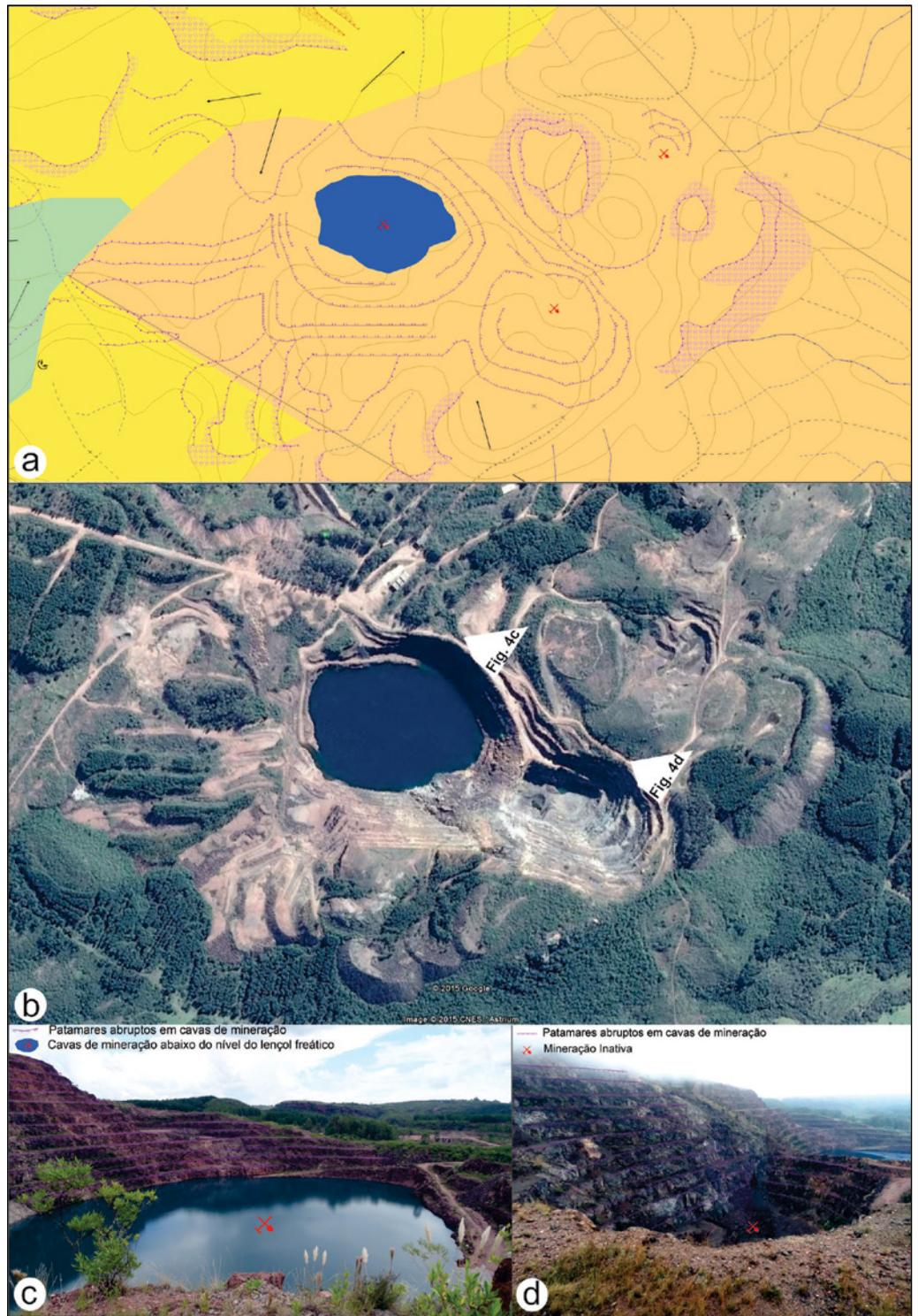
As morfologias criadas durante a etapa de escavação ou desmonte podem ser verificadas em escala de campo na Figura 4 (c, d). A magnitude dos patamares revela a intensidade das técnicas aplicadas para a exploração do cobre. A relação dos patamares com as curvas de nível originais da área evidencia as mudanças na topografia e na rede de drenagem derivadas da retirada do material superficial com o auxílio de maquinário ou por meio de implosões (Figura 4A).
